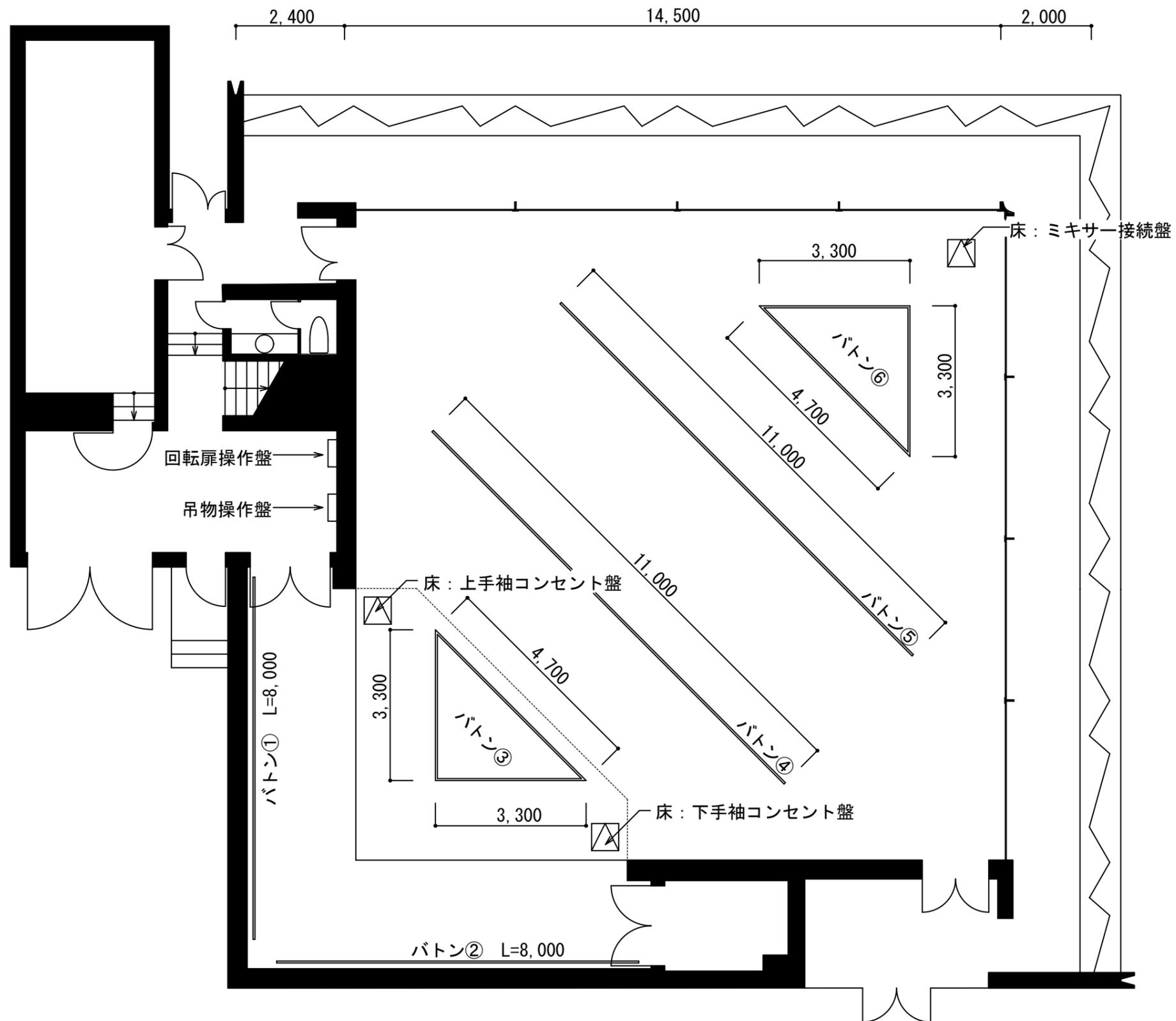
CUBE-A 吊物、操作・接続盤平面図
